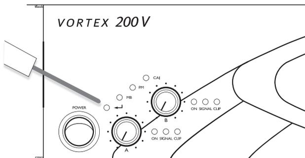
Daraufhin wird die aktuelle Adresse über die On-LEDs angezeigt:
