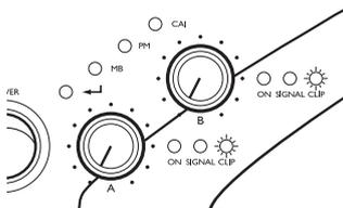
Die Intensität des grünen Farbanteils wird durch den Strom in der Endstufe des jeweiligen Kanals bestimmt (geringste Helligkeit entspricht ca. 1 A; größte Helligkeit = maximaler Ausgangsstrom). Rot wird bei Clip des entsprechenden Kanals aktiviert. Leuchten grün (Stromanzeige) und rot (Clip) gemeinsam, erscheint die Clip-LED gelb.
