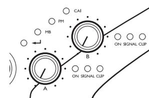
Stellen Sie die Lautstärke auf Null, bevor Sie die Endstufe einschalten, um Gehör- oder Lautsprecherschäden durch das plötzliche Auftreten von hohen Schallpegeln auszuschließen.
