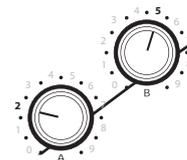
Die aktuell gewählte Adresse wird sofort angezeigt, aber **nicht** automatisch gespeichert oder aktiviert! Mit jeder Bewegung eines Pegelstellers startet die Timeout-Funktion erneut und läuft für 30 s. Durch **kurzes** Drücken von Enter ↵ können Sie den Vorgang verlassen, ohne die neue Adresse zu speichern, oder Sie warten, bis die Timeout-Funktion abgelaufen ist (s.o.).
